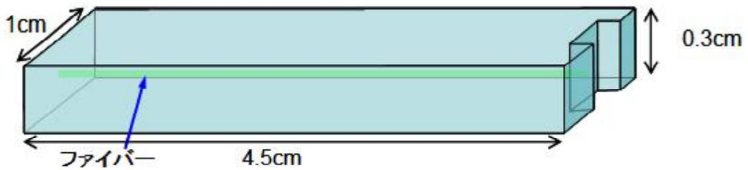
図 1.2 ストリップシンチレーター：右端のくぼみに MPPC を取り付ける。
