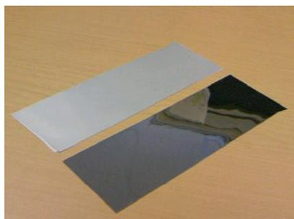
図 2.12 キモトフィルムの外見。反射面は片面のみである。
