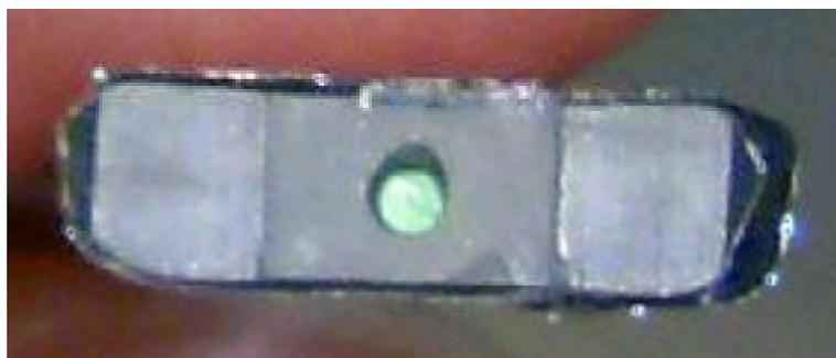
図 2.8 このシンチストリップの場合、ファイバーは上下の比が約 5 : 4 の位置を通っている。
