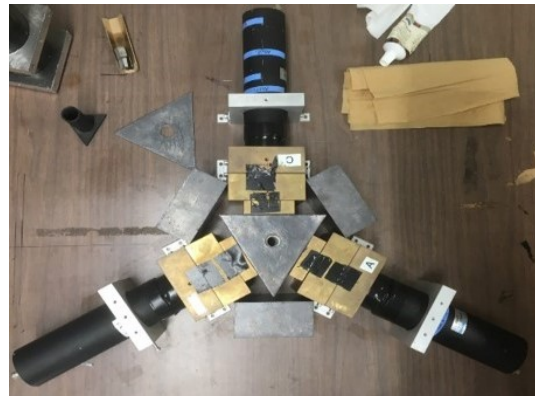
図 2.2.1 \gamma トリガー実験装置図 [2] を一部改変
