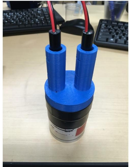
図 6.2.21: 3/8 インチ PMT の同時計測用具
