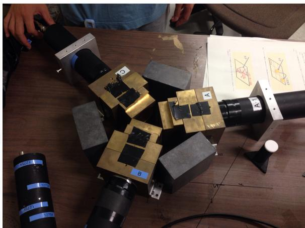
図 3.1.2: シンチレータ A,B,C の配置
