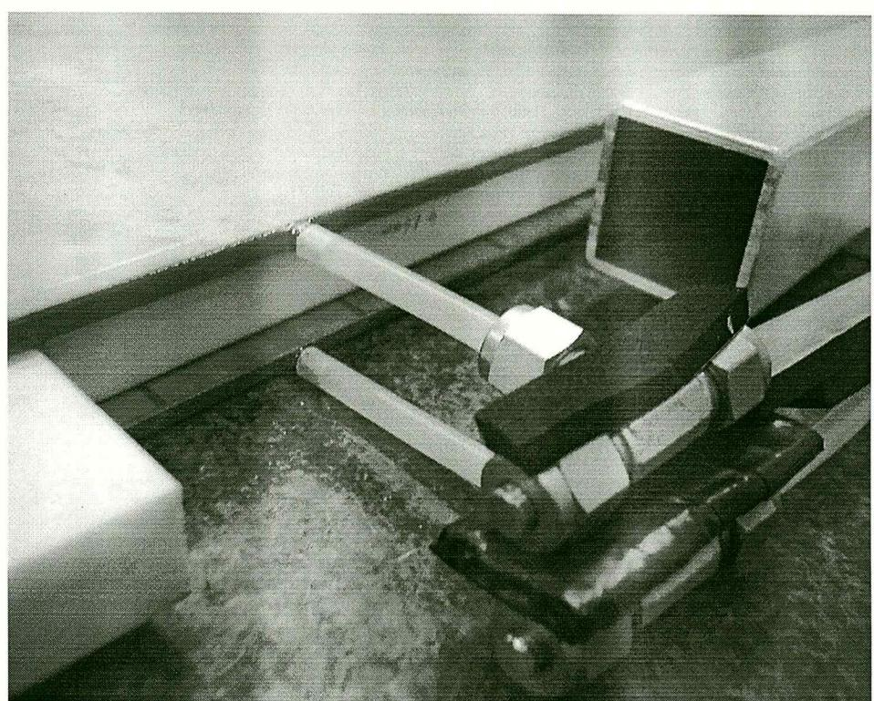
図 113: バギングフィルムをかぶせ減圧したときチェンバー内に内圧をかけチェンバーの平面性をとる。
