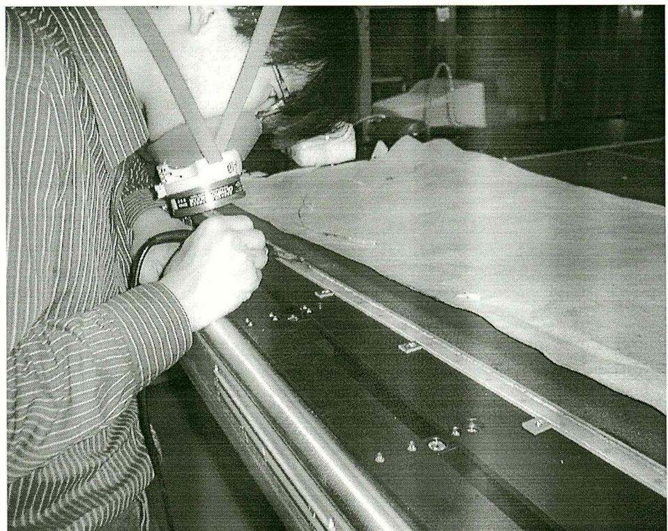
図 91: ハンダ付け作業の様子
