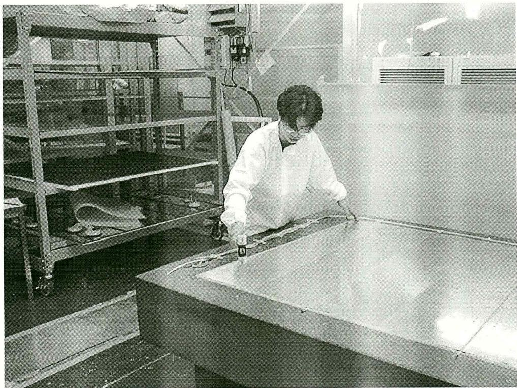
図 82: プラスチックハンマーで軽くたたき、パーツからはみでたアルダイトとアルミ治具を分離
