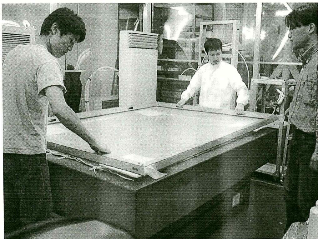
図 75: バギングフィルムをかぶせ、減圧する
