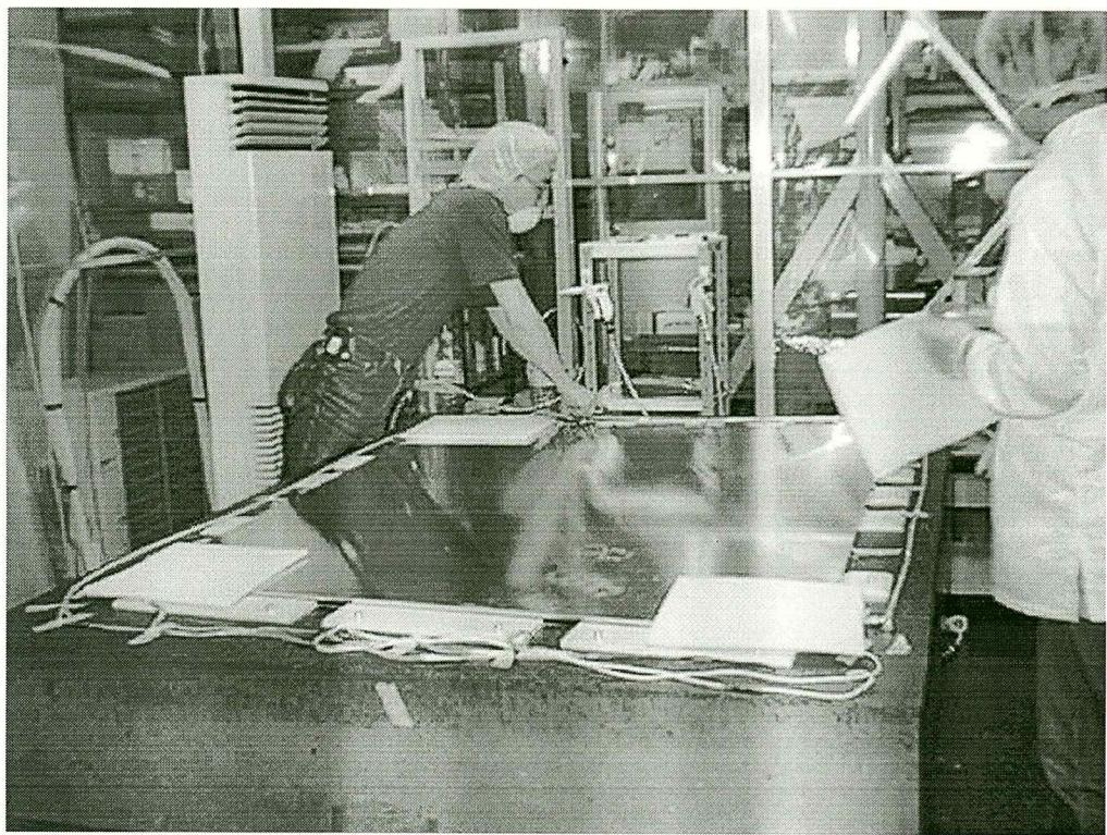
図 104: 真空ポンプで減圧した時にバギングフィルムが傷つかないよう、角にスポンジをおく
