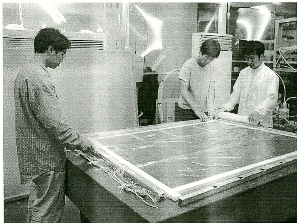
図 73: アラルダイトがバギングフィルムに付着しないようラップをかぶせる
