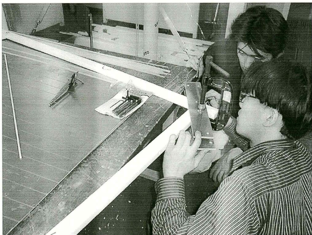
図 59: ハニカム外枠の製作作業
