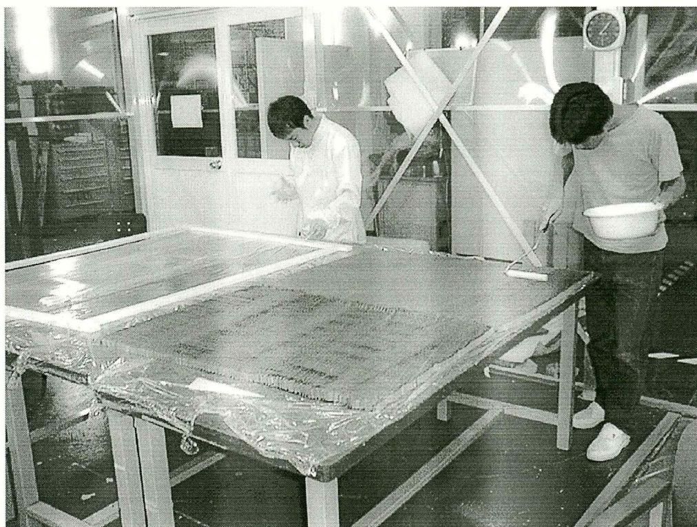
図 68: ハニカム外枠、ハニカムへの接着剤の塗布
