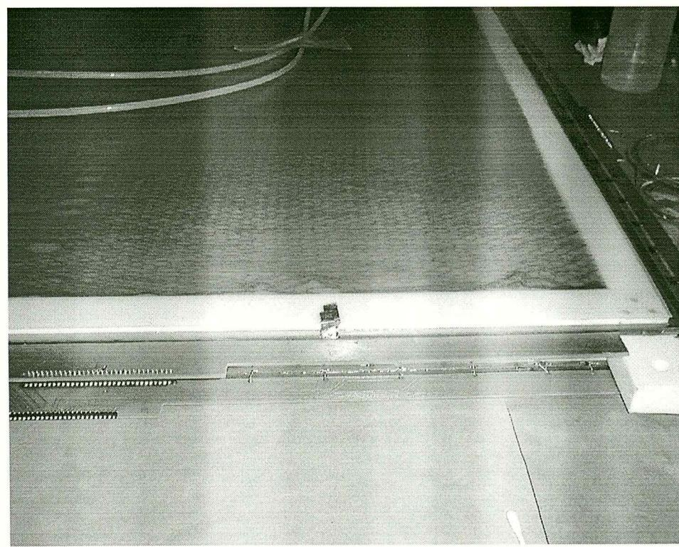
図 126: ストリップ側アダプター板を取り付けた状態。このとき銅テープ（グラウンドコンタクトテープ）は外側にくるように注意する。
