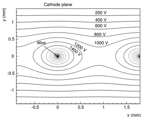
Figure 3.29: Equipotential lines in TGCs [36].
