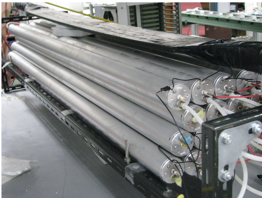
図 1.1: 今回実験に用いた Drift Tube と Scintillation Counter の外観 上下の黒い部分が Scintillation Counter、円筒状に並んだものが Drift Tube である
