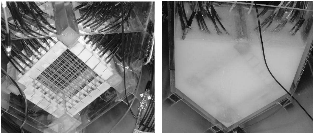
図 35: ビームテストで使用した検出器の写真。左が散乱体なし、右が散乱体を混入したものである。
