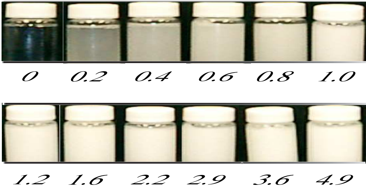
図 55: BC-517Lに CR-63を混入していったときの見た目の変化。絵の下の数値は散乱体濃度を表す。単位は g/l
