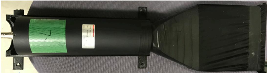
図 6.4 トリガー用に用いるシンチレータ (四角形の部分) と PMT(円筒形の部分)。
