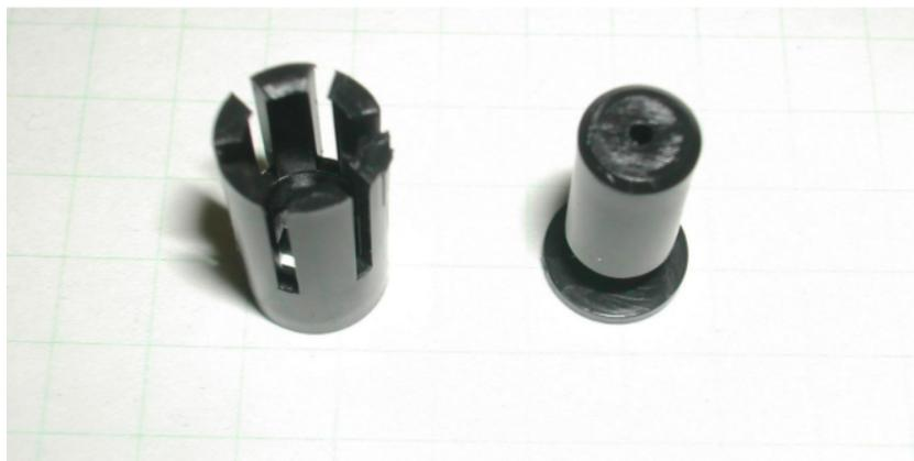
図 4.18 GOMI Connector 写真。左 : MPPC 側パーツ・右 : 波長変換ファイバー側パーツ。 [11]
