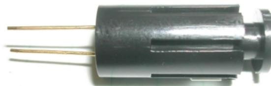
図 4.19 GOMI Connector に MPPC が組み込まれ、ファイバー側パーツと接続された状態 [11]。
