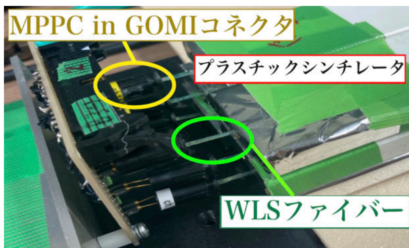
図 4.4 MPPC-in-GOMI コネクタ,WLS ファイバー, プラスチックシンチレータ
