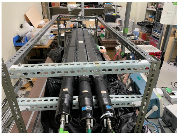
図 4.7 トリガーシンチレータの配置
