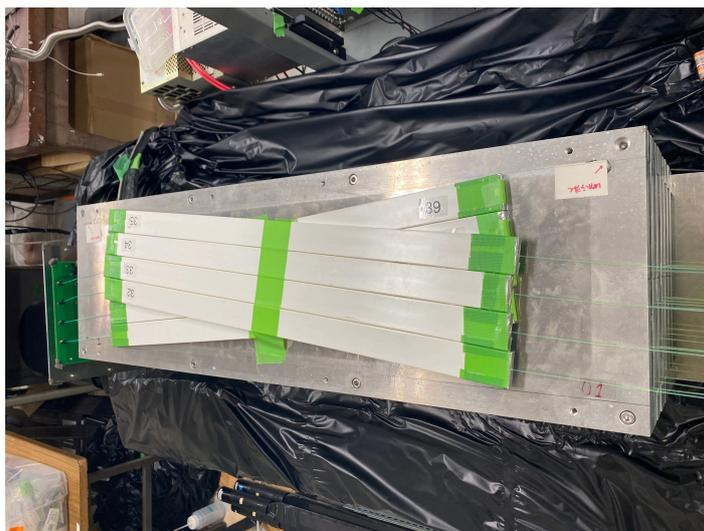
図 4.3 プラスチックシンチレータと光ファイバー
