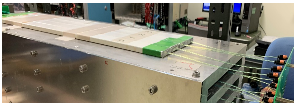
図 12: プラスチックシンチレータと波長変換ファイバー
