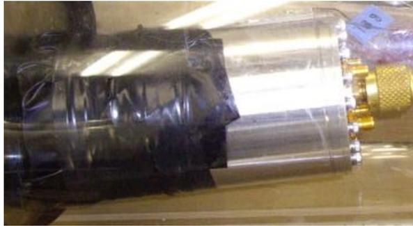
図 3.42: PMT の光電面につけたマスク
