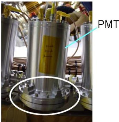
図 3.11: ライトガイドホルダーに固定され測定器に取り付けられた TOF-PMT
