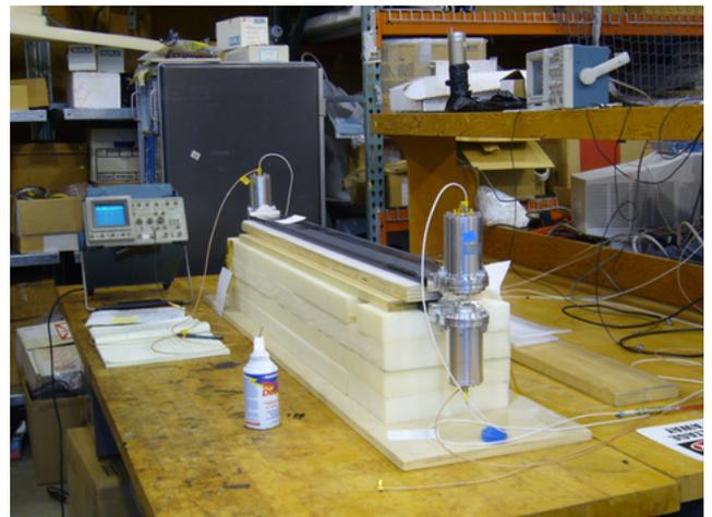
図 2.11: TOF カウンターのシンチレータパドルとその両端に取り付けられた PMT
