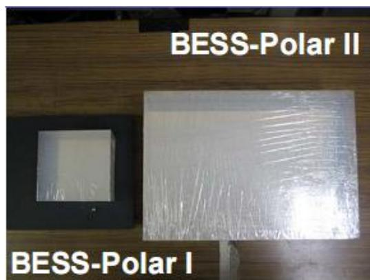
図 2.14: ACCに搭載するエアロジェルブロック
