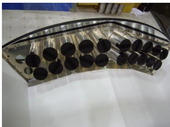
図 2.13: ACCに取り付けられたPMT
