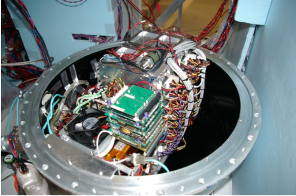
図 2.17: 圧力容器に封入した CPU と HDD
