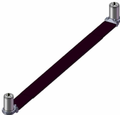
図 5.24: シンチレータパドルの両端に取り付けられた PMT
