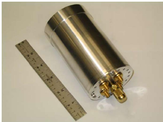
図 3.6: TOF-PMT 用アルミニウム製気密容器
