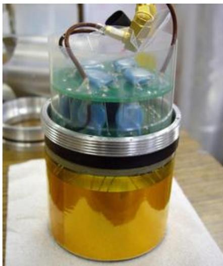
図 3.1: 浜松ホトニクス社製 FM-PMT R6504
