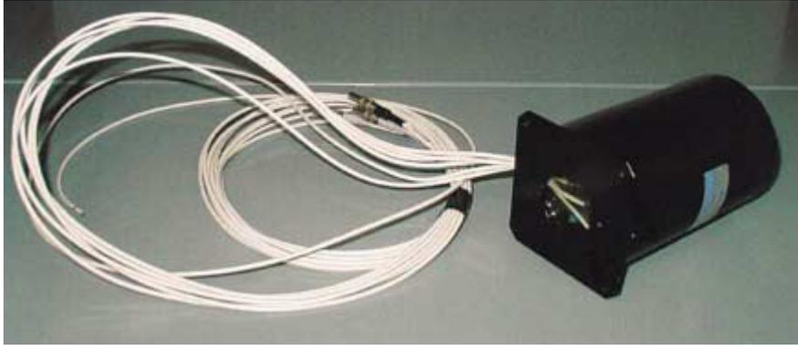
図 3.4: BESS-PolarI で使用された TOF カウンター用 PMT
