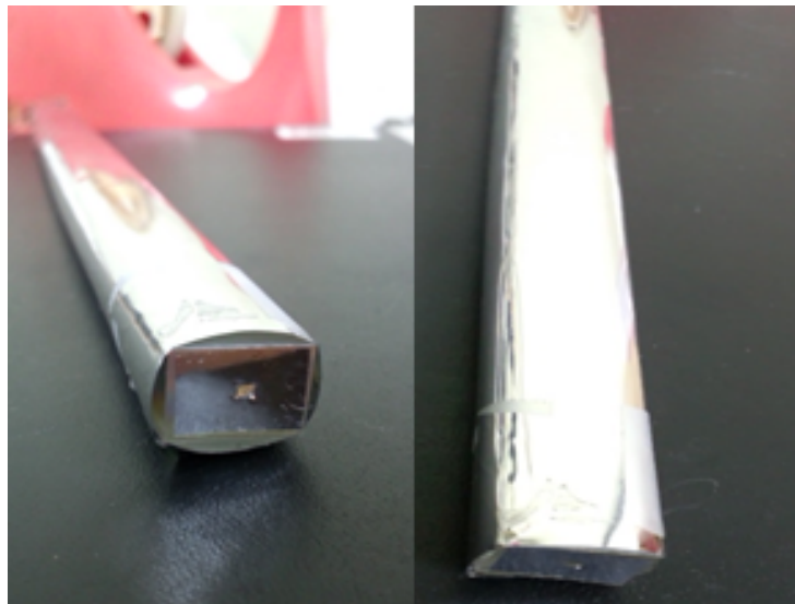
図 42: アルミマイラーをまいたプラスチックシンチレータ
