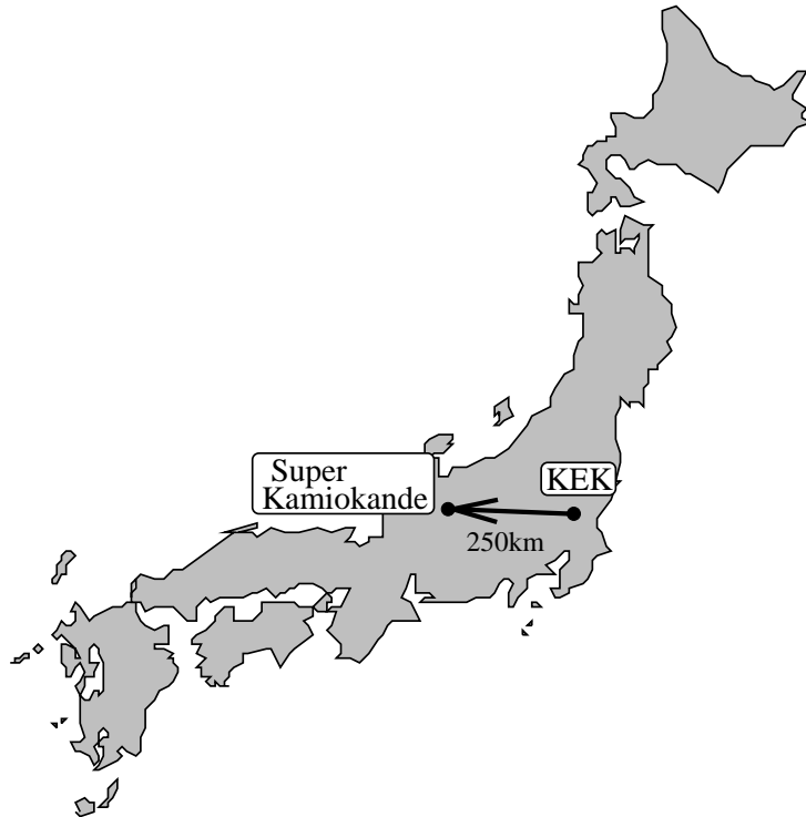
図 2.1: つくば-神岡間長基線ニュートリノ振動実験. 茨城県つくば市にある高エネルギー加速器研究機構から岐阜県吉城郡神岡町にあるスーパーカミオカンデ検出器へニュートリノビームを照射し, ニュートリノ振動の有無を検証する実験である.
