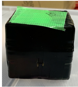
図 3.19 本研究で用いた CsI(Tl)(写真中央の金属の 2 本の突起は PIN フォトダイオードの足)
