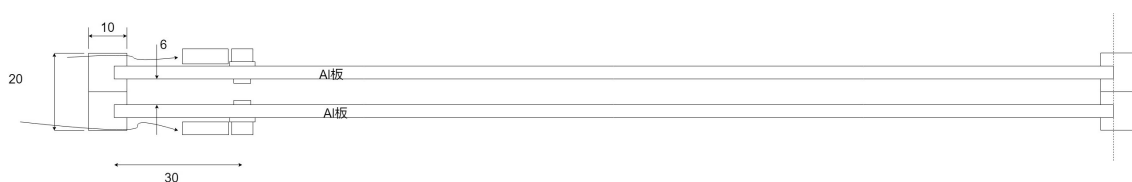
図 4.4 スパークチェンバーを横からみた図
