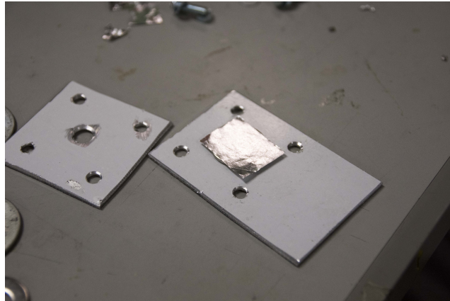
図 2.9 製作途中のターゲットホルダー
