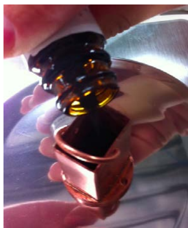
図 5.15: Carboxen-1021 を本研究で開発した銅容器に入れている様子
