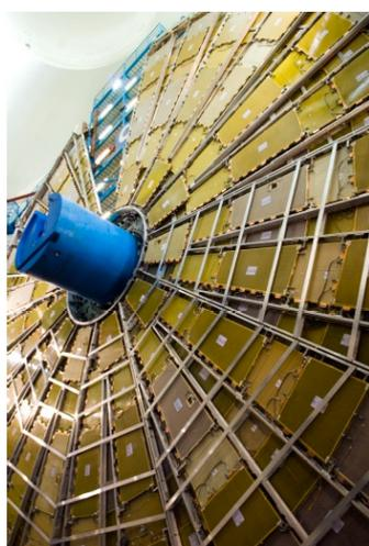
Fig. 6.3: TGC チェンバーの配置の様子 [18]。隣り合うチェンバーを前後にすらして一部が重なるように設置されている。
