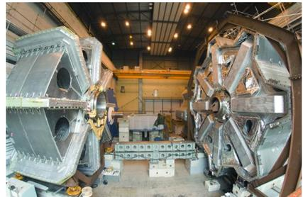
Fig. 2.17: エンドキャップ部超伝導トロイド磁石 [1]
