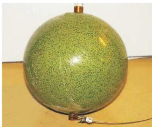
図 4.1: SK 実験で Ni/Cf 較正に用いられている線源 [37]
