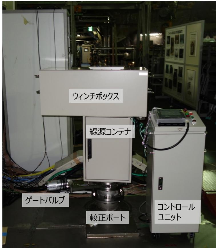
図 3.16: SK 検出器較正ポート上に設置された自動線源ポジショニング装置
