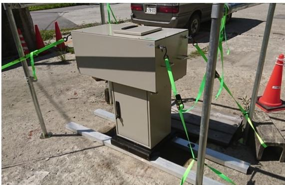
図 3.14: 試験のセットアップの写真, C チャンネルと装置をクランプで肯定し, ベルトで装置の四方を固定した.
