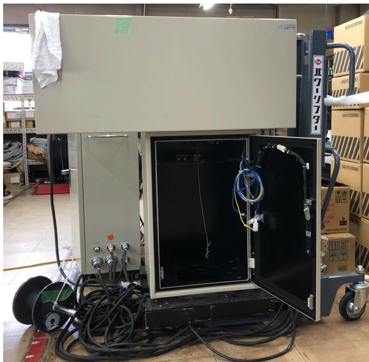
図 3.4: 自動線源ポジショニング装置の写真
