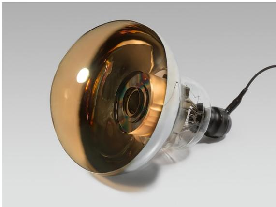
図 2.8: 新たに開発された PMT(R12860) の写真 [32]
