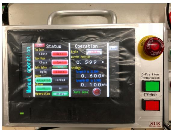
図 3.11: コントロールパネル, 当初はコントロールボックス埋込式で画面も小さかったがユーザーエクスペリエンス向上の為大型画面かつフルカラー化し手持ち操作を可能にした。
