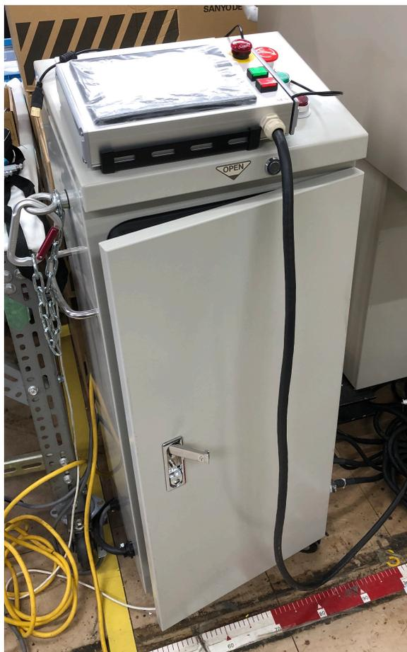
図 3.10: コントロールボックスの写真, ボックスの上ののついでのがコントロールパネル
