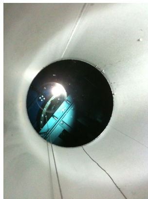
図 3.6: キャリブレーションホールから吊るしたガンマ線源容器
