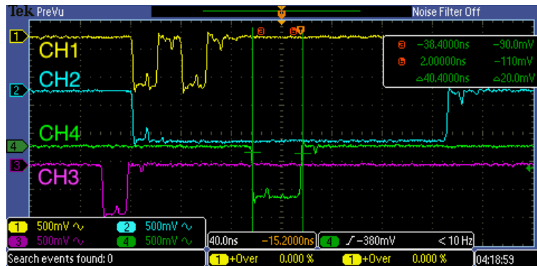
図 2.16: オシロスコープで確認された TDC の波形
