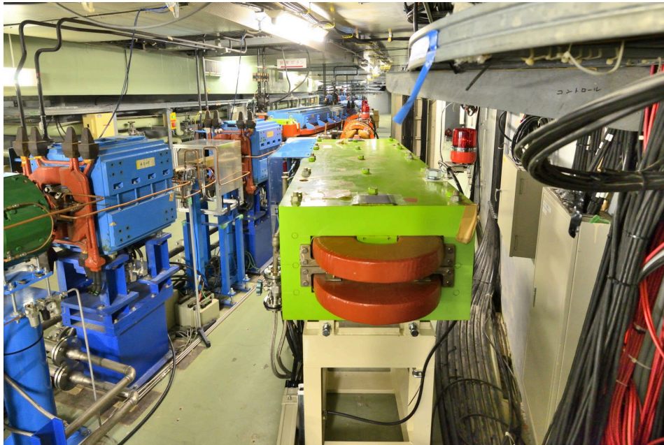
図 3.4: B マグネットの写真 [7]。中央のオレンジ色の二つの半円が B マグネットである。B マグネットは特定の運動量を持った電子のみを取り出すために用いられている。
