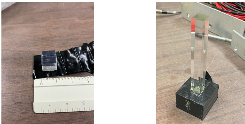
図 4.4: 使用したターゲットの写真。左側の 1cm×1cm×1cm のプラスチックシンチレータを、右側のライトガイドに接着する。実際には PMT に取り付け、遮光する。
