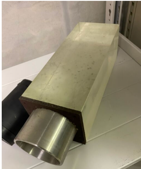
図 4.10: 鉛ガラスの写真。実際には遮光し、PMT を接続して使用する。
