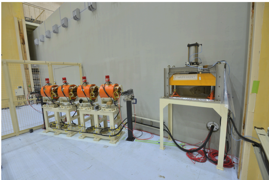
図 3.3: ビームステージの写真 [7]。右側の黄色い装置は「ビームシャッター」、左側の4つのオレンジ色の装置は「Q マグネット」、フェンスの奥が「テストビームエリア」である。Q マグネットにより、写真の右から左に向かって電子ビームを輸送する。
