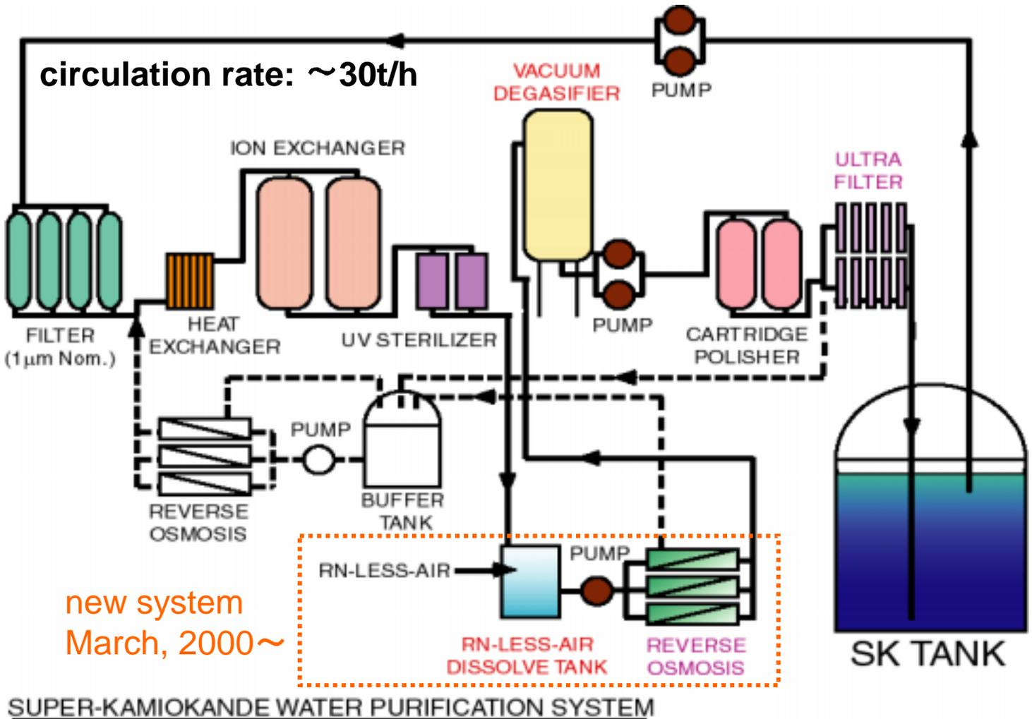
UF:  $\sim 100\%$  remove for  $>100\text{nm}$  particles
