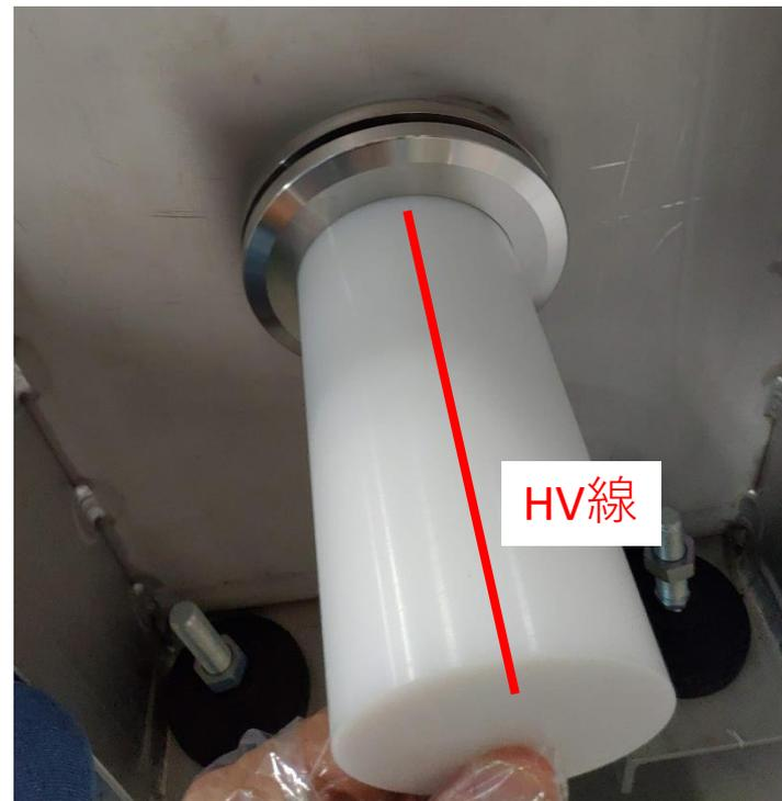
現状空気中で-11 kV印加で放電
