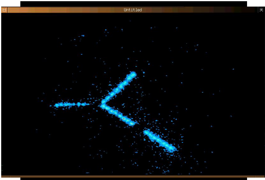
図 61: ファイバーバンドル内で散乱した粒子のトラック。粒子は左方向から入射し、途中で核子と衝突している。
