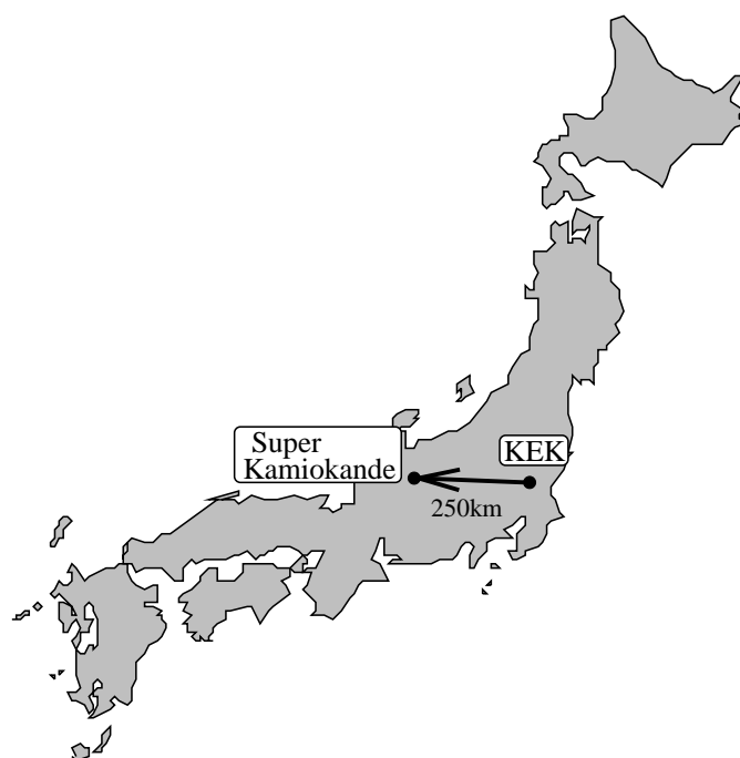
図 2: つくば-神岡間長基線ニュートリノ振動実験。茨城県つくば市の高エネルギー加速器研究機構から約 250km 離れた岐阜県吉城郡神岡町のスーパーカミオカンデに向けてニュートリノビームを発射する。
