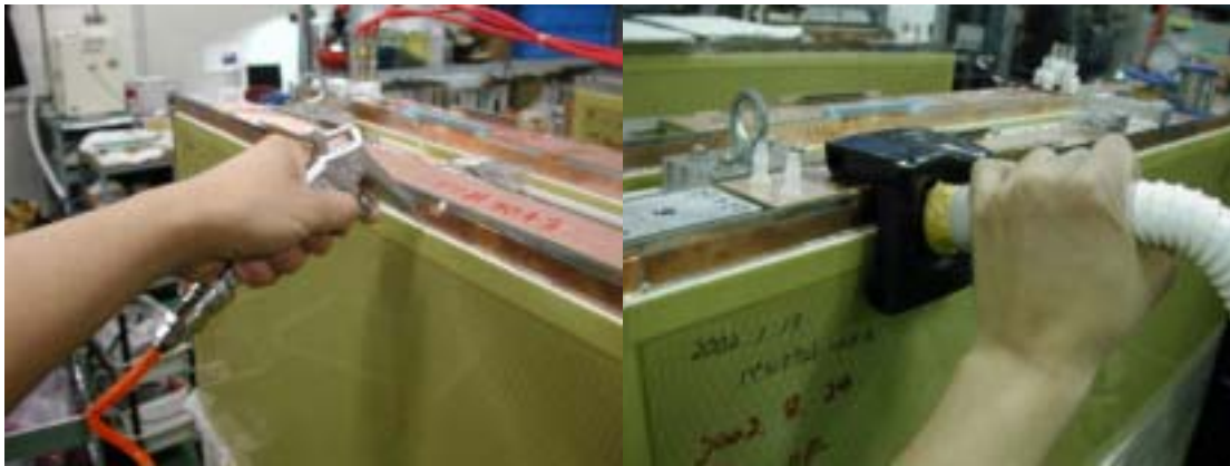
図 3.6: リーク箇所を見つける 2 つの方法。左がコンプレッサを用いる方法で、右が掃除機で吸引する方法。
