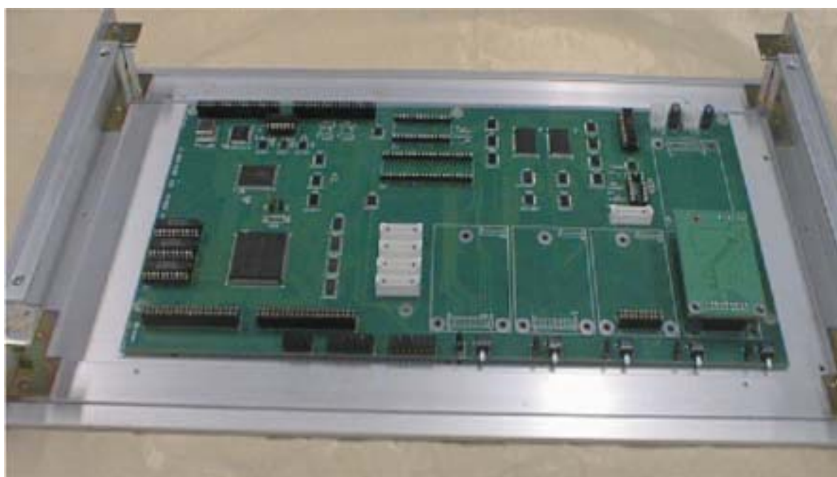
図 4.3 C-Bridge 上：メインボード、サブボード、LON モジュール 下：メインボードと LON モジュール
