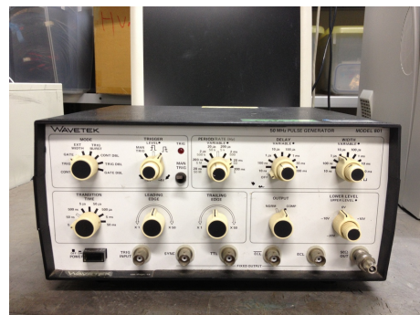
図 3.10: WAVETEK 製 pulse generator MODEL 801: パルスの立ち上がり、立ち下がり時間を調節する機能を持つ、いわゆるファンクション・ジェネレータ
