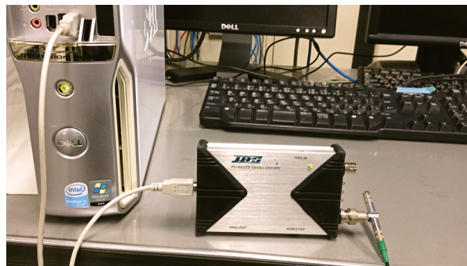
図 3.6: 日本データシステム (JDS) 製 オシロスコープ UDS-5204S
