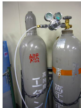
図 2.14: Ar:C 2 H 6 =1:1 の混合ガスが密封されたガスタンク
