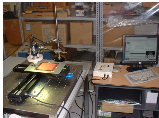
図 2.9: 自動表面検査システムの拡大図 図 2.10: 自動表面検査システムの全体図
