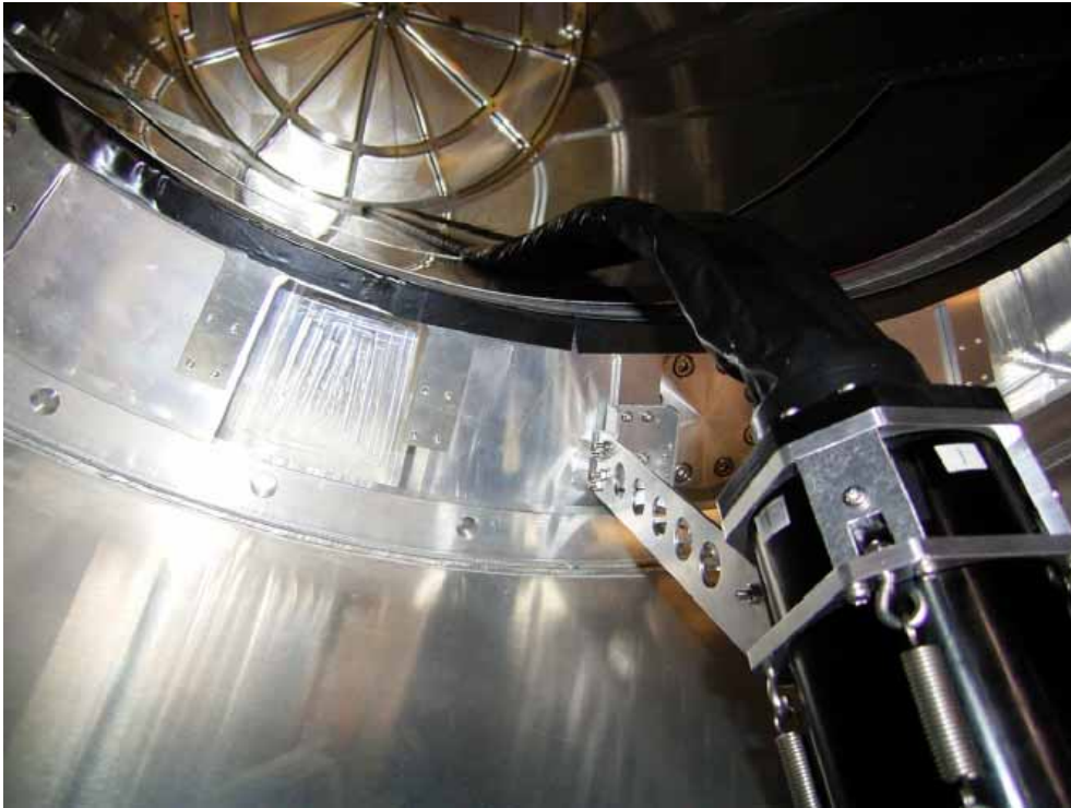
図 4.8: PMT サポートフレーム 右下に PMT 固定用のバネとフックが見える。
