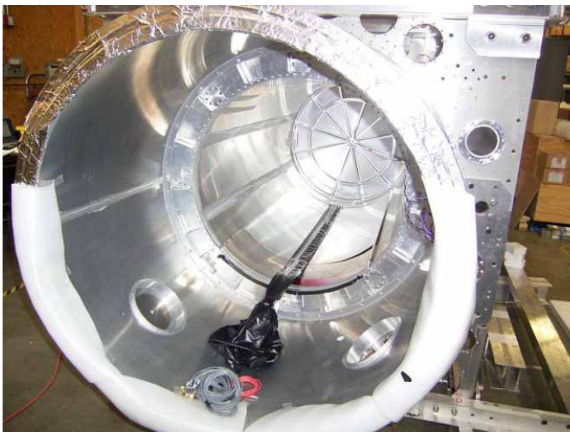
図 5.24: 磁場テストの写真。BESS-Polar 測定器内の本来の位置に設置して試験を行った。
