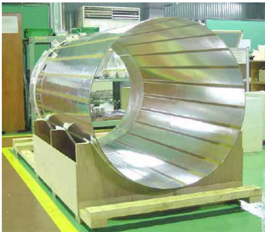
図 2.6: BESS-Polar 用極薄肉超伝導コイル
