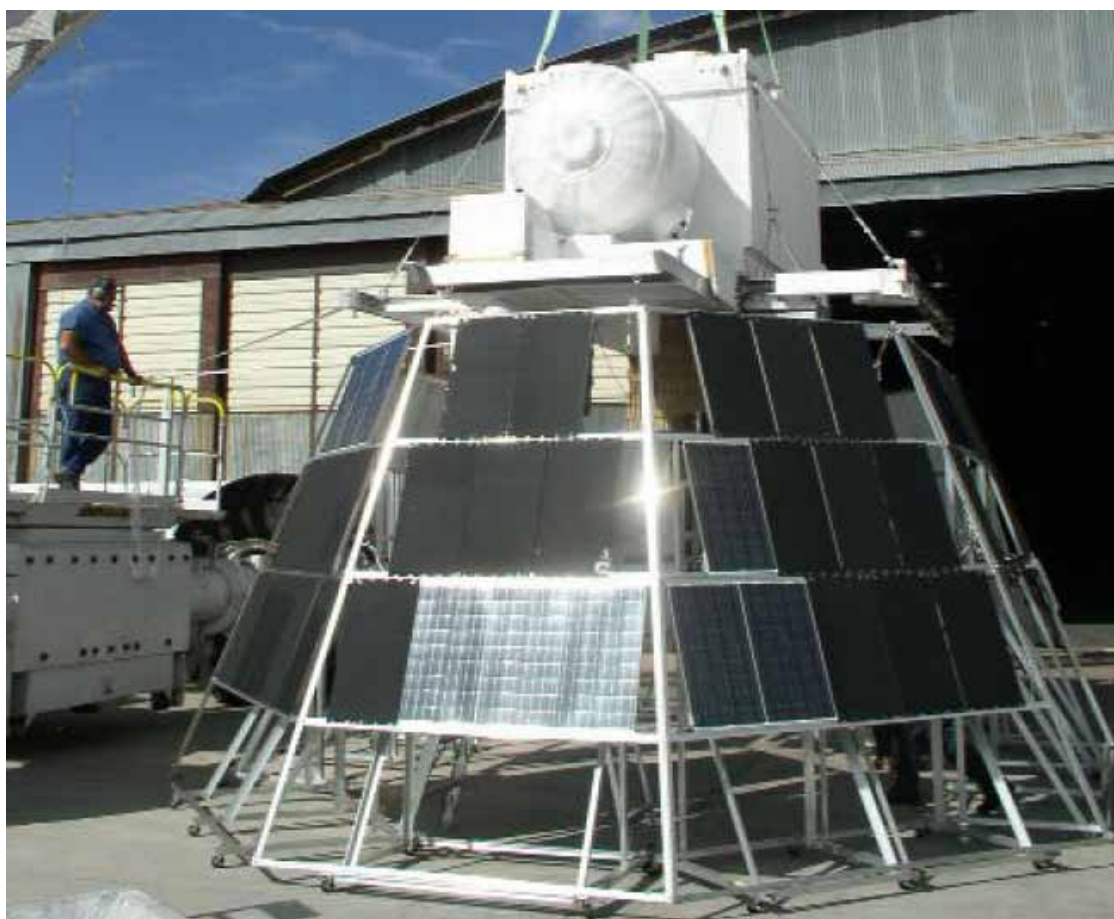
図 2.7: 太陽電池パネルと BESS-Polar 測定器
