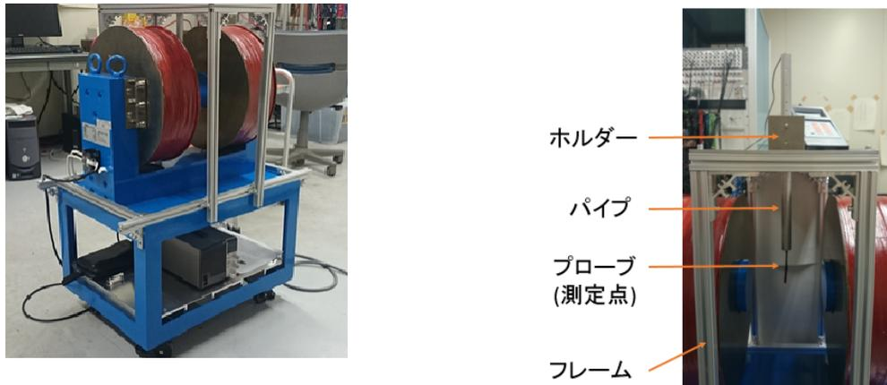
図 3.19: プローブの固定
