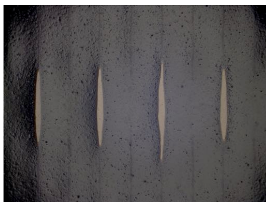
図 4.21: ストリップ幅の設定値 250\mu\text{m} の薄膜、ストリップというよりはほとんどベタ膜のようになってしまった
