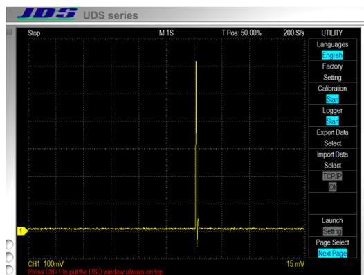
図 5.2 DSO Roll モードでの放電測定画面例
