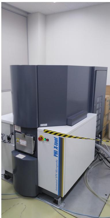
図 6.8 走査型光電子分光分析装置
