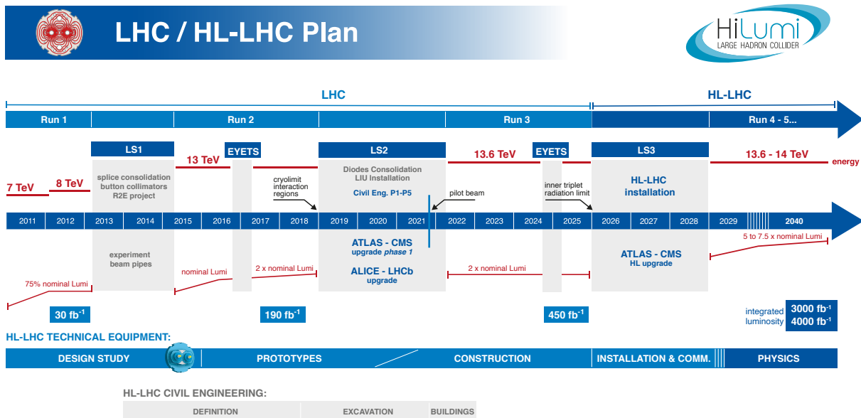
図 2.2: LHC 加速器の運転とアップグレード計画 [11]。LHC では 2019 年から 2022 年初旬までの間に Phase-1 Upgrade が行われ、現在は Run-3 として運転を再開している。
