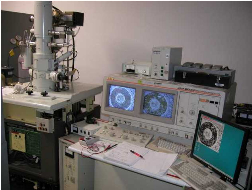
図 5.1 我々の使用している走査電子顕微鏡(日本電子製 JSM-6000FS)。画像はビデオキャプチャに JPEG 形式で保存され、パソコンのモニターに表示される。
