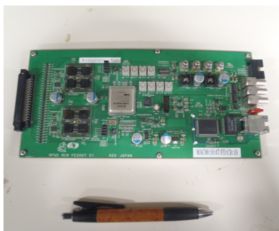
図 2.10(c) : これ 1 枚でパソコンに差せば多チャンネルの信号が読める。
