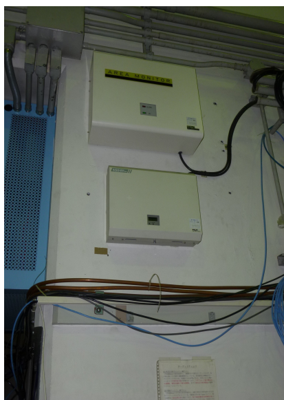
図 5.10 (a) 中性子エリアモニター(上) γ線エリアモニター(下)
