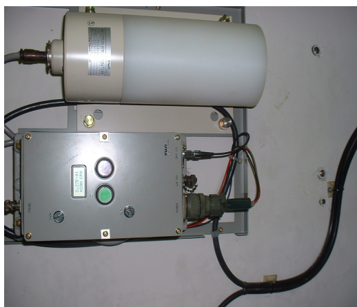
図 5.10 (b) 外枠を外した中性子エリアモニター : 白いのが減速剤のポリエチレン
