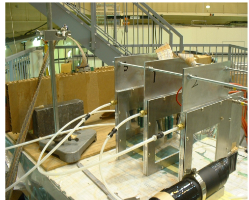
図 4.4(b) \mu -PIC \times 3, シンチレータ \times 2, fineTGC \times 1
